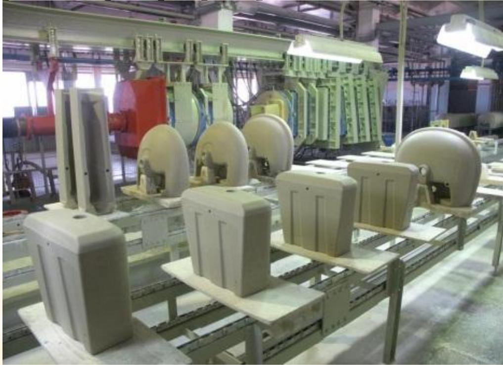
Завод «Стройфарфор» является лидером на отечественном рынке санитарной керамики. По уровню оснащённости завод не уступает ведущим мировым производителям. Для производства применяются современные технологии: литьё под давлением в полимерные формы, глазурование на автоматических линиях с роботами напыления, обжиг в современных, печах.
