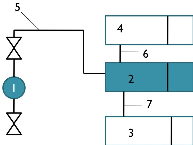
*1 – устье скважины; 2 – АДПМ; 3,4 – автоцистерны, 5 – нагнетательная линия от АДПМ; 6,7 – приемная линия АДПМ; Радиус опасной зоны 50м.*
