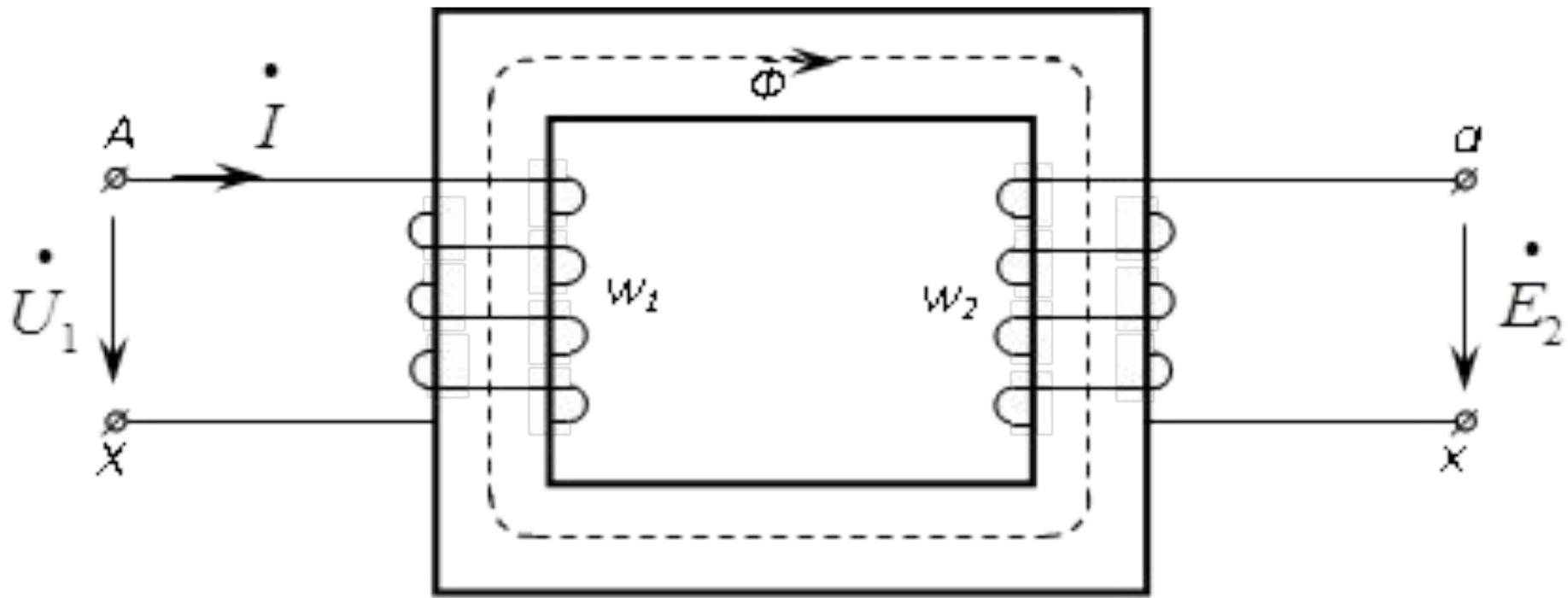
Рис. 2-1. Двухобмоточный трансформатор.
