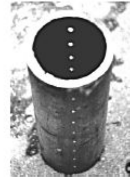
стальная труба \varnothing 150 \times 12 мм с зацементированными отверстиями \varnothing 6 - 12 мм
