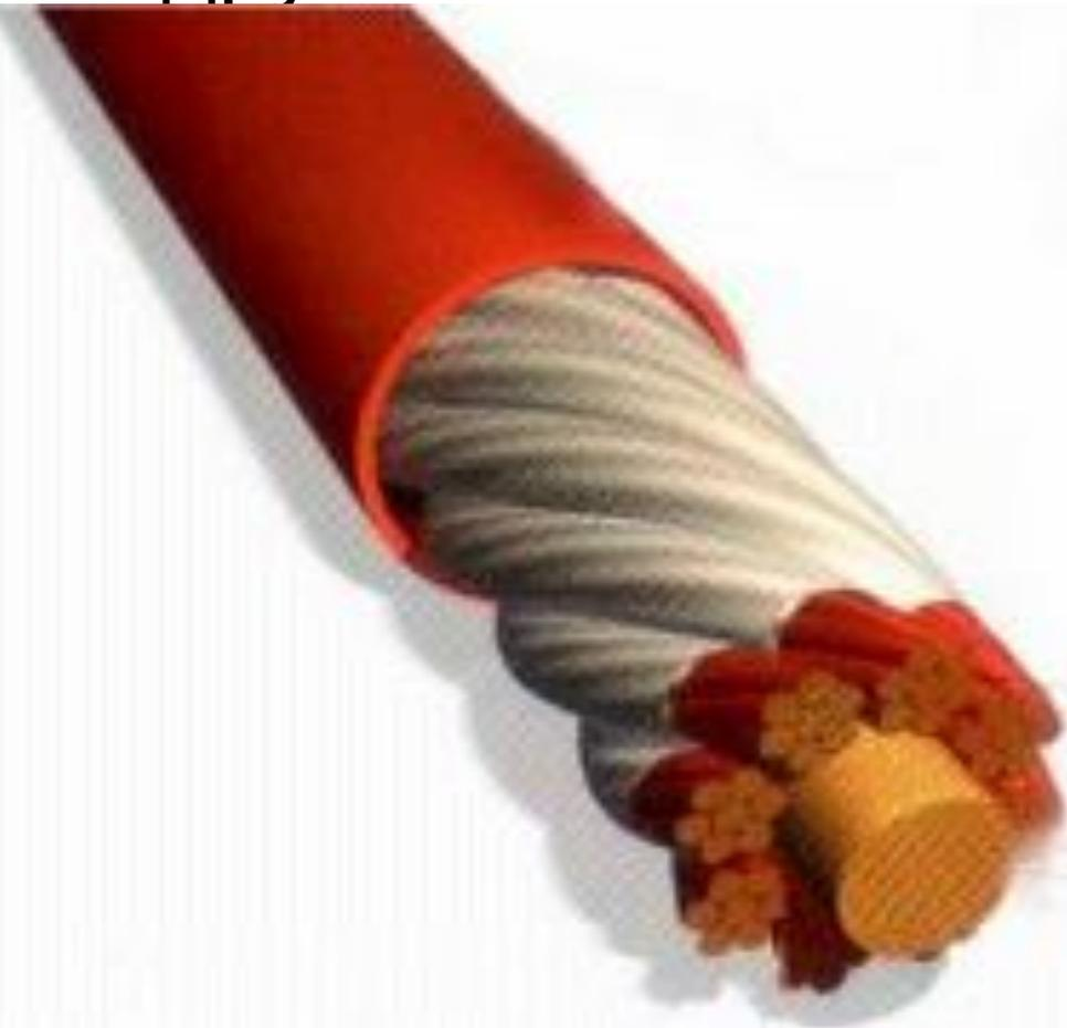
**Лицендрат** - это система переплетенных медных проводов, в которой каждая жила изолирована от соседних. Лицендрат предназначен для использования на высокочастотных токах для предотвращения возникновения паразитных токов и токов Фуко.
