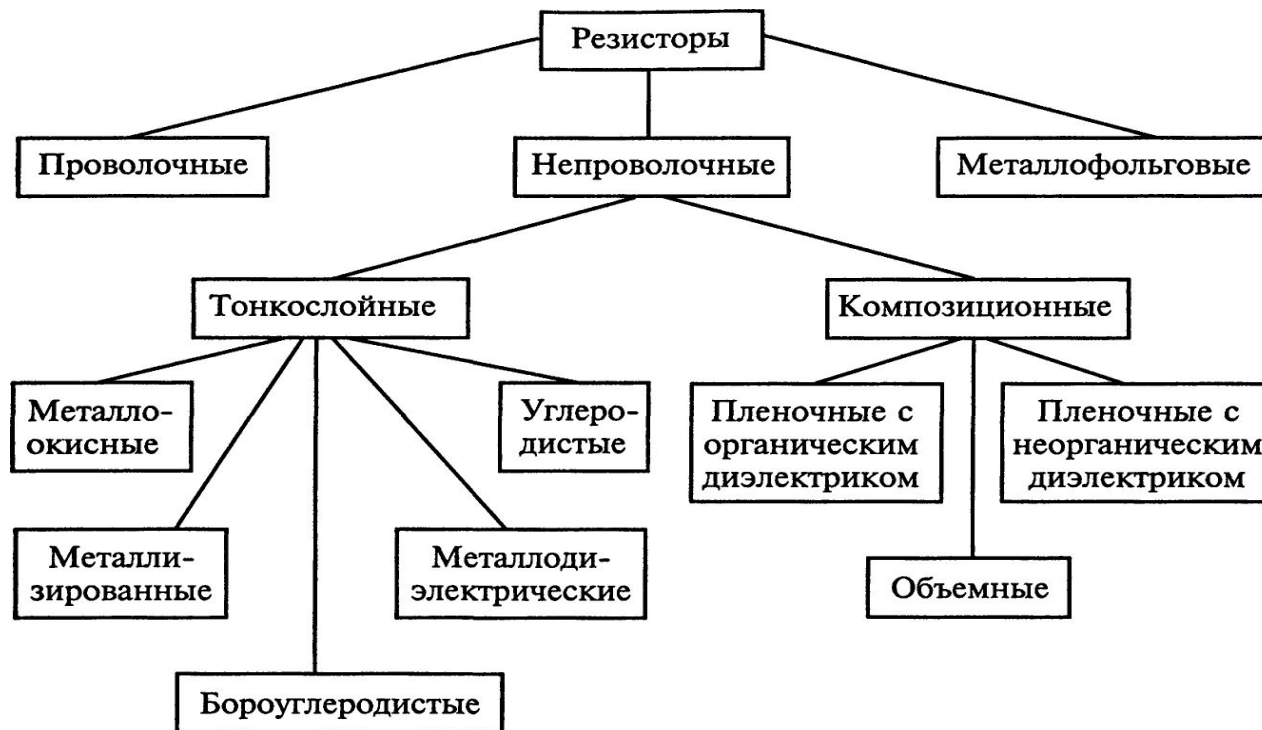
Классификация резисторов по материалу резистивного элемента
