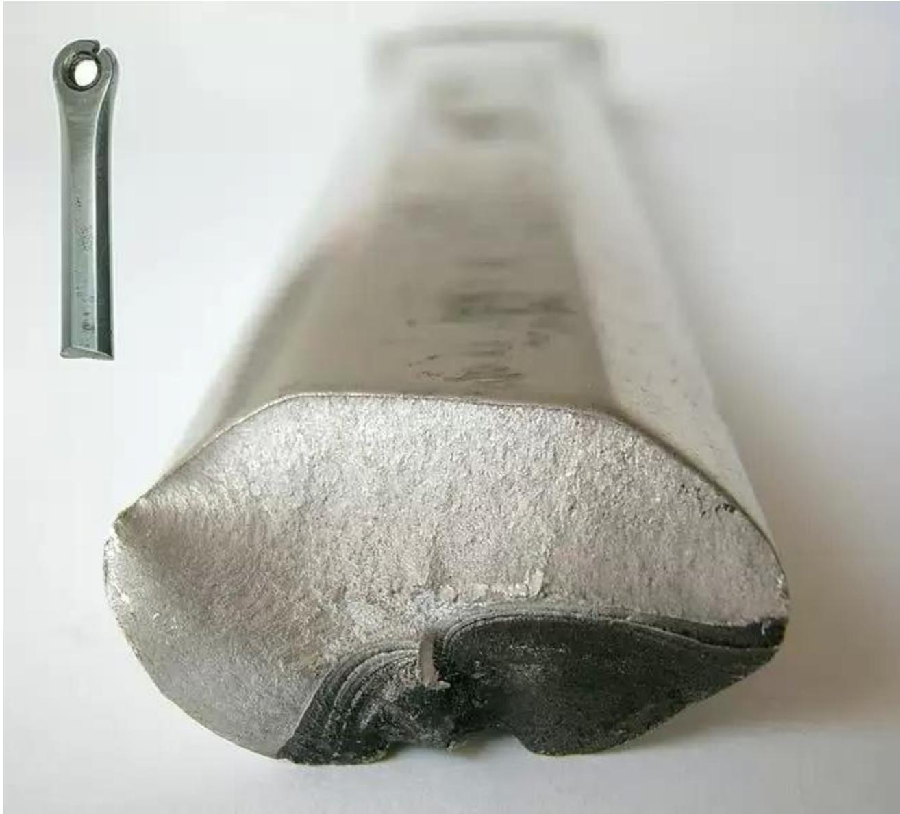
Число циклов до появления первой трещины и до полного разрушения стержня будет тем больше, чем меньше напряжение. Характерно, что разрушение материала под действием повторно-переменных нагрузок может произойти при напряжениях ниже предела текучести. Разрушение материала под действием повторно-переменных напряжений называется разрушением от усталости.
