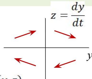
*В верхней полуплоскости фазовые траектории направлены слева направо, так как при увеличении  $y$  её производная по времени  $z > 0$ . В нижней полуплоскости фазовые траектории направлены справа налево, так как при уменьшении  $y$   $z < 0$ .*
