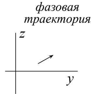
По виду фазовых траекторий можно определить устойчивость системы и характер переходных процессов.
