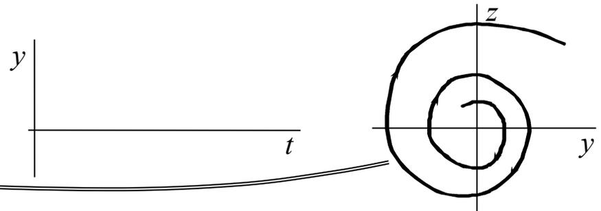
**Вывод:** затухающие колебания на фазовой плоскости изображаются в виде сходящихся спиральных кривых;
