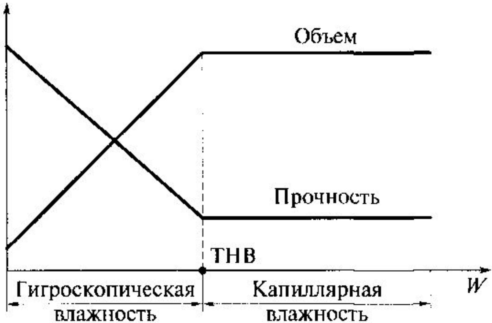
Влияние влажности на объем (усушку—разбухание) и прочность древесины
