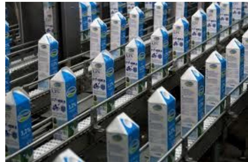
Сүт пен кілегей өндіру «Tetra Pak» фирмасының жаңаша желілерінде жүзеге асырылады. Ағымдағы өндіріс көлемі тәулігіне 150 тонна өнім шамасында.
