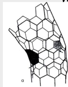
Локтевое соединение между кресельной и зигзажной нанотрубками
