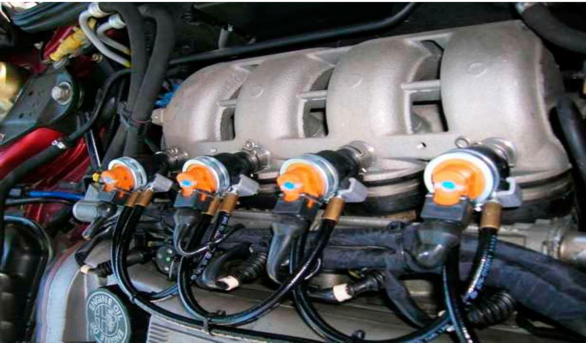
Заключительным элементом механической составляющей газобаллонного оборудования 5 поколения являются форсунки, установленные во впускной коллектор, которые и производят дозировку и подачу газа, все еще в жидком состоянии, в камеры сгорания.
