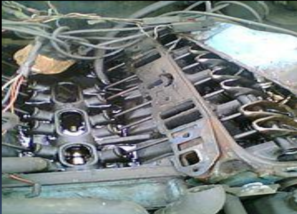
Двигатель с ГРМ типа OHV фирмы Chrysler.
