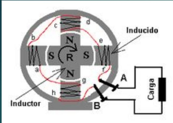
Принцип действия генератора основан на законе электромагнитной индукции — индукирование электродвижущей силы в прямоугольном контуре (проволочной рамке), находящейся в однородном вращающемся магнитном поле.
