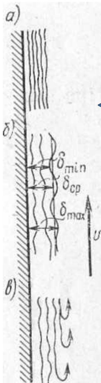
**Стекание пленки жидкости по вертикальной стенке:**
