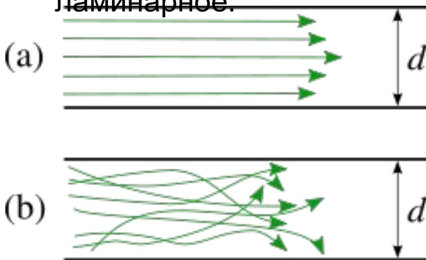
Основываясь на результатах опытов, Рейнольдс установил, что режим движения жидкости зависит от скорости потока, плотности и вязкости жидкости, диаметра трубы. Эти величины входят в безразмерный комплекс — критерий Рейнольдса
