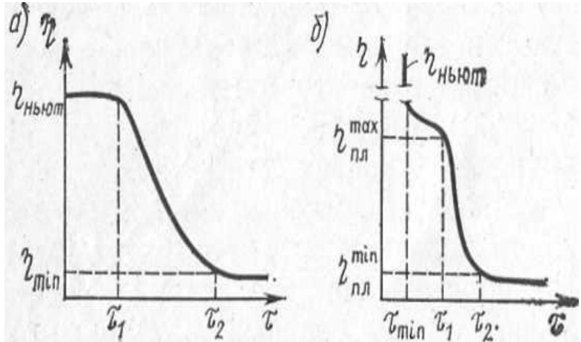
*Изменение вязкости в зависимости от напряжения сдвига для жидкообразных (а) и твердообразных (б) систем*
