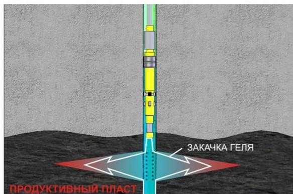
ЗАПОЛНЕНИЕ ТРЕЩИНЫ ПРОПАНТОМ
