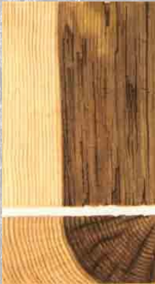
Бурая трещиновая ядровая гниль (ель)
