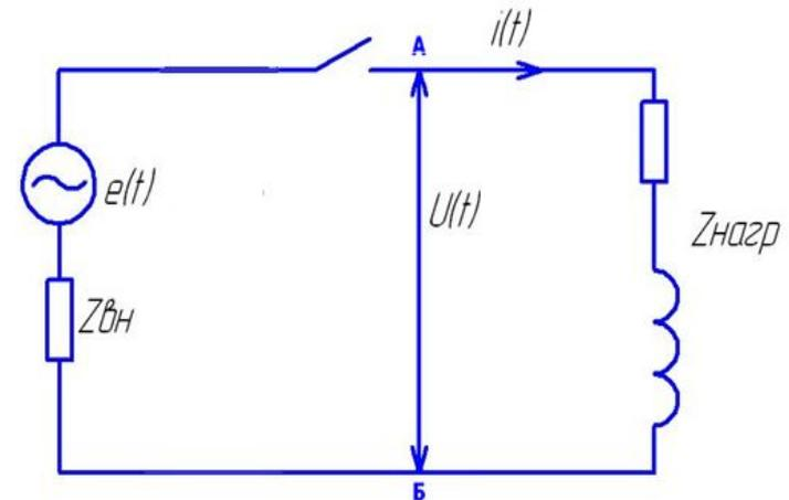
Схема замещения контура с активно-индуктивным характером нагрузки
