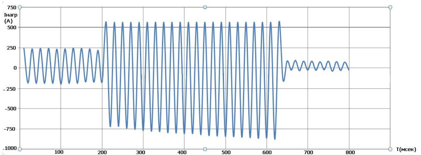
При коммутации цепи с активно-индуктивным характером нагрузки выброса не наблюдается что противоречит теоретическим положениям и результатам проведенного моделирования. Возможно выброс не регистрируется из-за малой чувствительности платы в силу большого времени опроса или ошибками вызванными большим уровнем помех.
