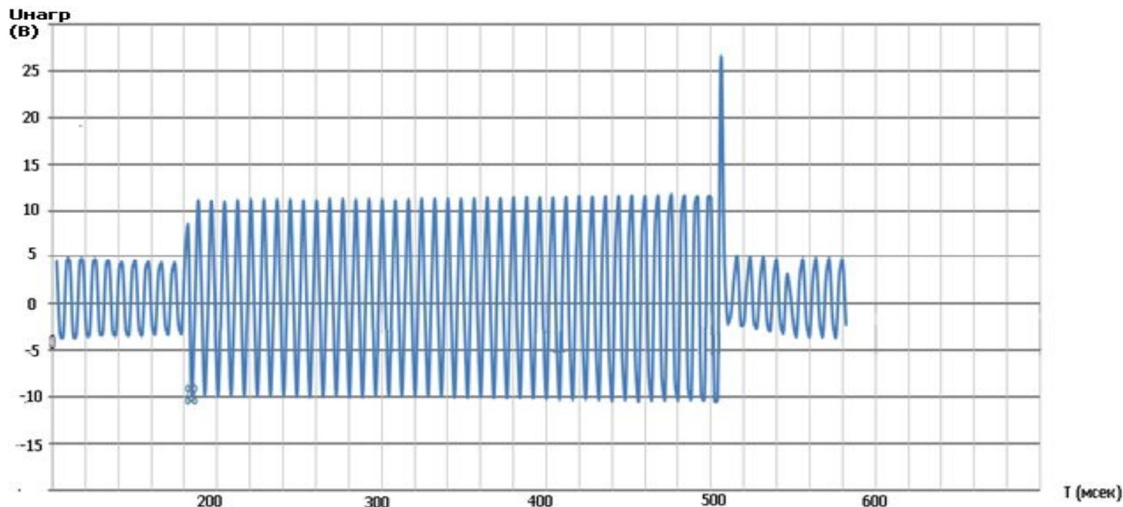
В момент коммутации нагрузки отчетливо виден резкий скачок напряжения всплеск амплитуды напряжения с номинальной амплитуды 10В до 27В, чему соответствует коэффициент кратности  $K=2,7$ . Длительность перенапряжения в виду больших помех точно определить не представляется возможным.
