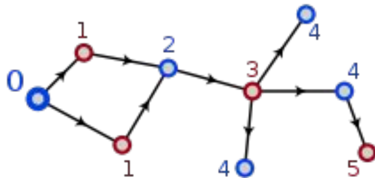
Проверка двудольности с помощью чётности расстояний
