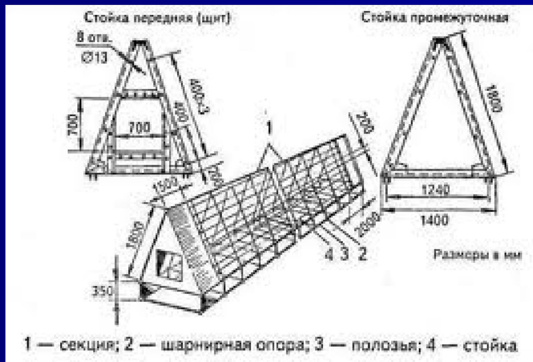
Воздухораспределитель для сушки сена
