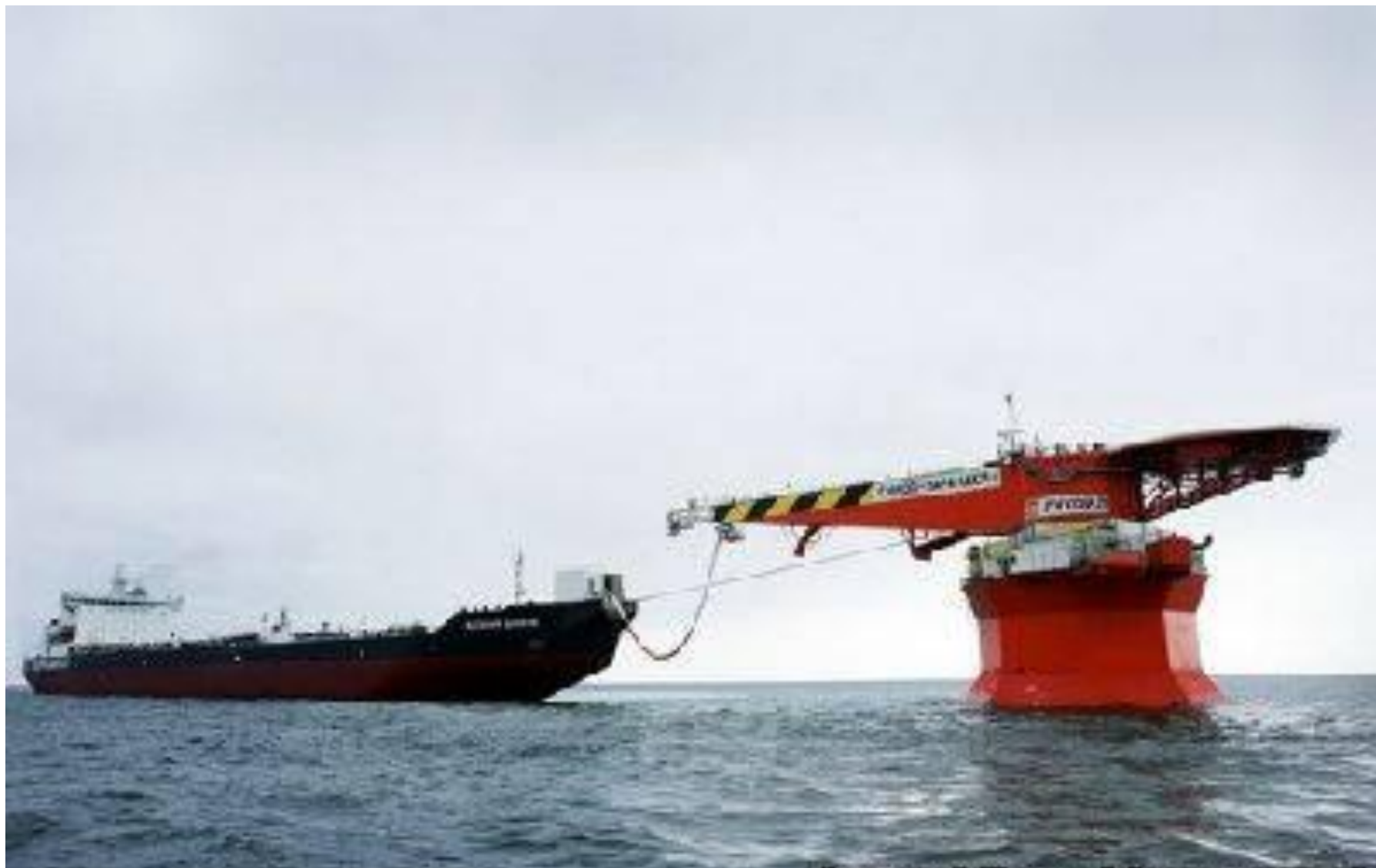
Грузообработка танкера у точечного причала
