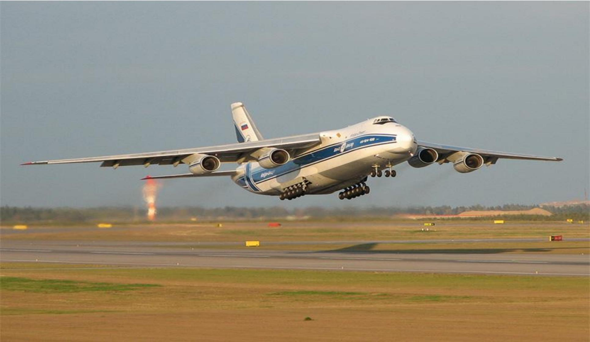
Ан-124 предназначен для доставки войск, боевой техники и вооружения из глубокого тыла на театры военных действий, перевозки крупногабаритных грузов в любую точку земного шара. В самолете широко применяются композиционные материалы. Пол выполнен из титанового сплава
