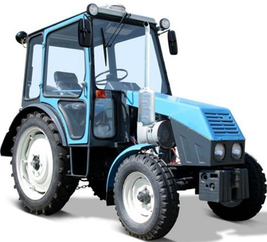
Колёсные тракторы можно использовать на дорогах общего пользования, где они могут развивать большую скорость. Однако их сила сцепления с землёй ограничена, а следовательно, ограничена и сила тяги. На рыхлой почве такие тракторы могут пробуксовывать. Для устранения этого недостатка были созданы тракторы с приводом на все колёса, однако такие машины отличаются большим весом и
