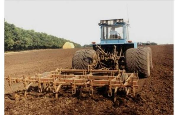
Трактор ХТЗ Т-17022 оснащен рядным 6-цилиндровым двигателем BF6M1013E, "Дойц АГ", Германия. Рациональное распределение веса между ведущими мостами, шины увеличенного размера и двухцилиндровая навесная система повышенной грузоподъемности повышают производительность труда до 15 % при погектарной экономии топлива до 12 %. Возможно агрегатирование с тяжелыми импортными орудиями.
