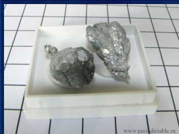
Цинк, полученный путём электролиза
