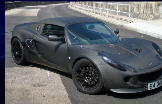
Автомобиль, кузов которого выполнен из карбона
