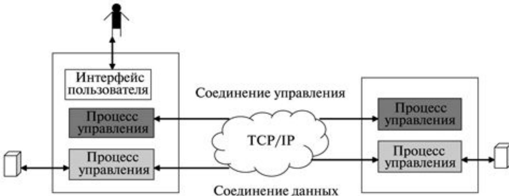
Два FTP-соединения – для передачи команд управления и передачи данных — используют различные стратегии и различные номера портов
