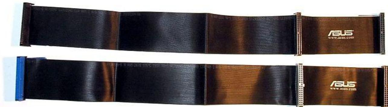
Шлейфы АТА (IDE): 40-проводной сверху, 80-проводной с кабельной выборкой снизу
