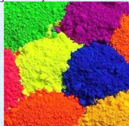
**Красные пигменты** – железный сурик – тонкий порошок оксида железа кирпично-красного цвета; искусственная мумия – пигмент, имеющий различные оттенки в зависимости от соотношения составных частей  $\text{Fe}_2\text{O}_3$  и  $\text{CaSO}_4$ ; природная мумия – тонкий минеральный порошок, окрашенный в естественных условиях оксидами железа в красный цвет; свинцовый сурик – порошок красно-оранжевого цвета, содержащий в основном  $\text{PbO} \cdot \text{Pb}_2\text{O}_3$ .
