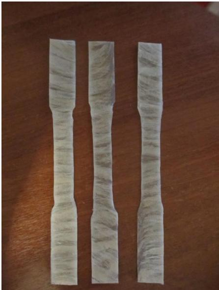
Образцы для испытаний на растяжение
