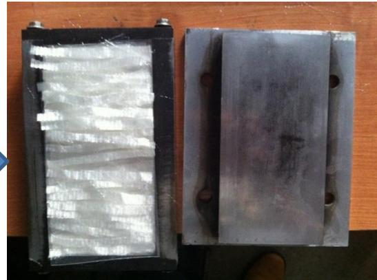
2. Подготовка формы и сборка пакета из 11 слоёв (Размер пресс-формы= 200 x 100 мм)
