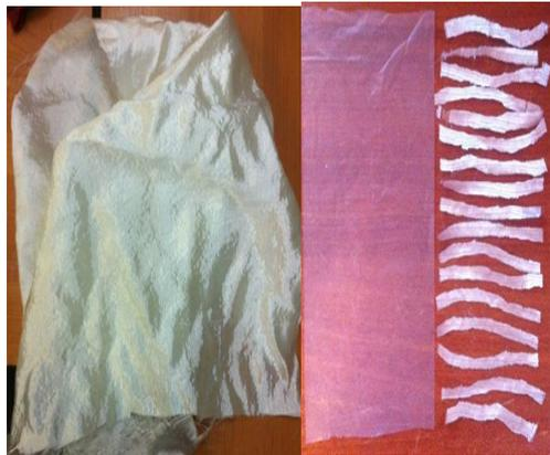
1. Раскрой тканого полуфабриката ТОПАС и полиамидной плёнки на заготовки.
