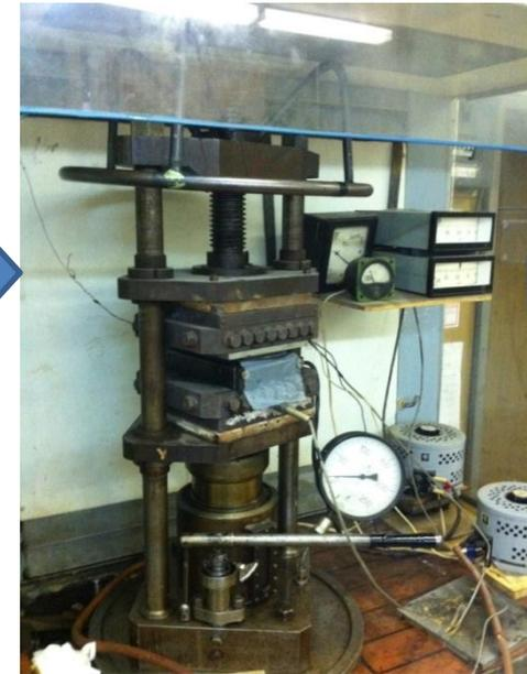
3. Прессование при  $T = 240^{\circ}\text{C}$ ,  $P = 2,5 \text{ МПа}$ ,  $t = 15 \text{ мин}$ ;
