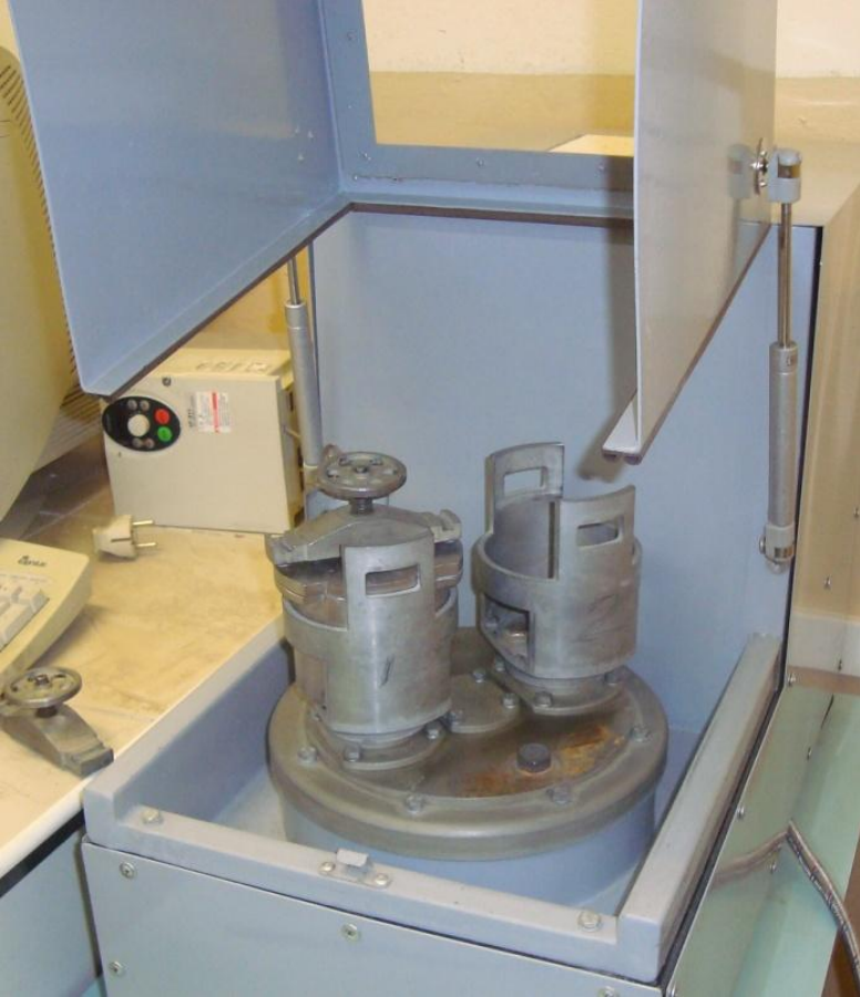
Рисунок 1- Планетарная мельница “Активатор-2SL” Технические характеристики Скорость вращения центральной оси - 1000 об/мин (макс.) Скорость вращений барабанов -1500 об/мин (макс.) Время разгона до максимальной скорости — 30 сек.
