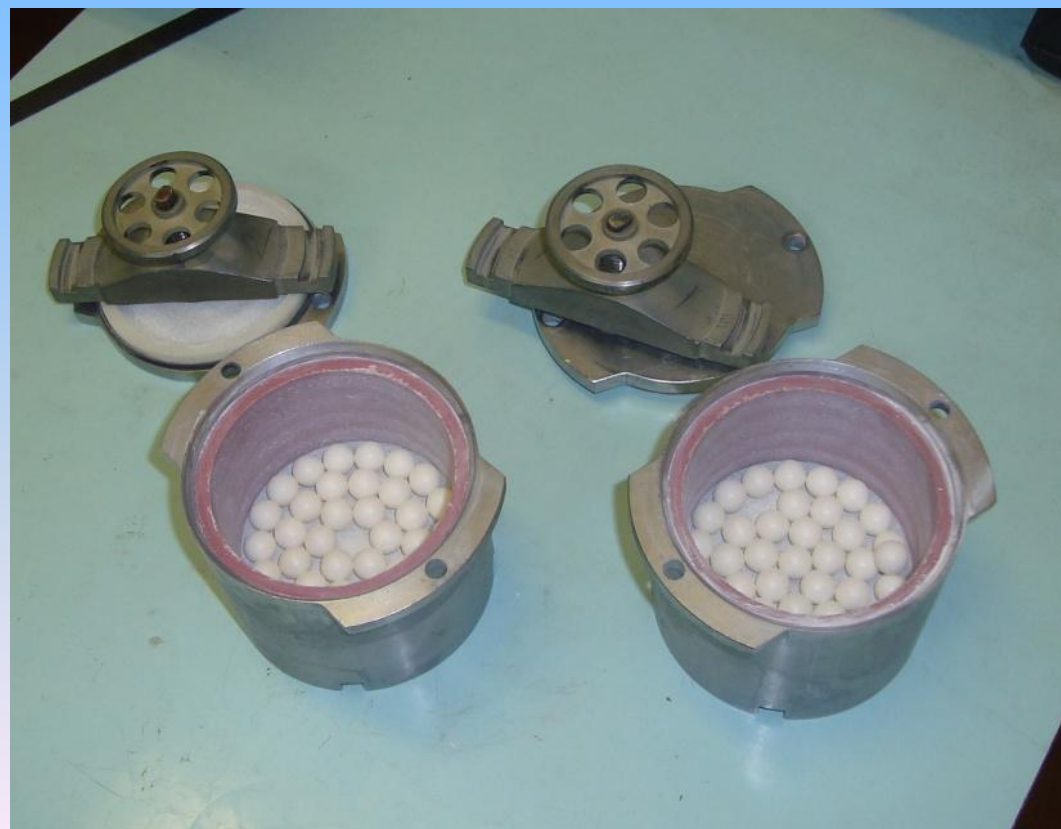
Рисунок 1- Планетарная мельница “Активатор-2SL” Технические характеристики Скорость вращения центральной оси - 1000 об/мин (макс.) Скорость вращений барабанов -1500 об/мин (макс.) Время разгона до максимальной скорости — 30 сек.
