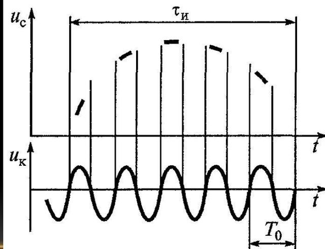
Измерение интервалов времени с помощью калибровочных меток
