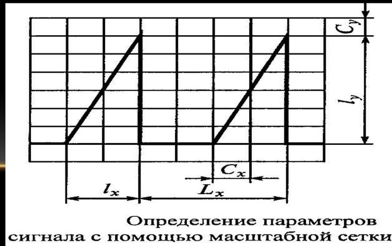
В отличие от частотомеров и измерителей временных интервалов, с помощью осциллографов можно измерять параметры сигналов сложной временной структуры, например ступенчатых сигналов или сигналов кодовых последовательностей. Можно измерять параметры случайных и переходных процессов. Наиболее простым методом исследования является метод калиброванной развертки (калиброванных меток). Реальная погрешность этого метода составляет порядка 10 % и зависит от количества меток.
