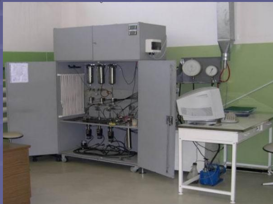
Определение сжимаемости пор горных пород в термобарических условиях
