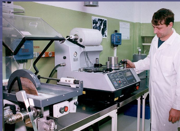
Изготовление петрографических шлифов
