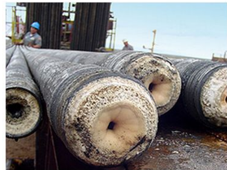
Отложения парафинов на трубах
