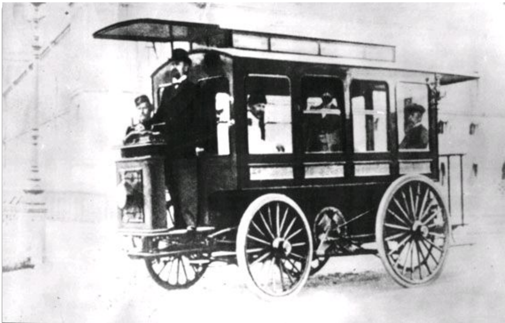
Электрический омнибус конструкции И.Романова, 1901г. Запас хода — 60км., мест- 17, скорость- 11 км/ч.
