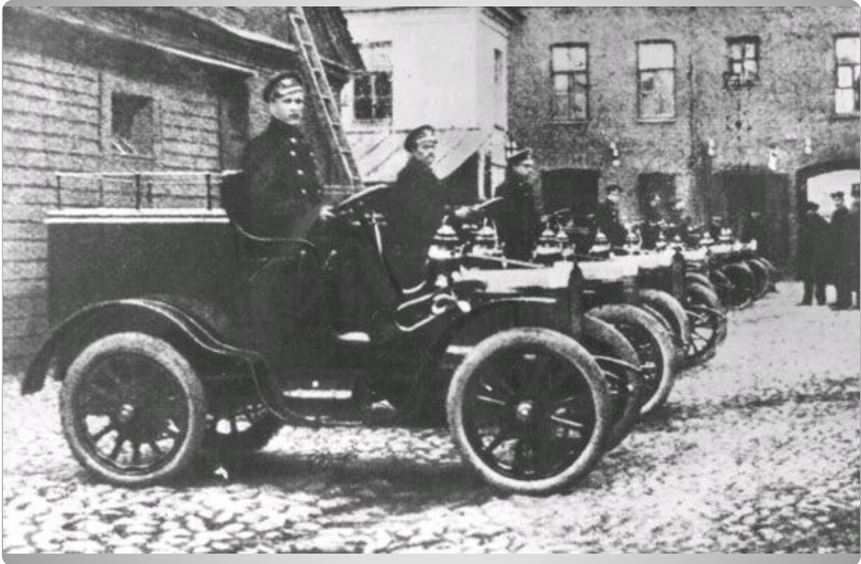
Почтовый автомобиль завода "Лесснер", 1905 г. скорость- 30 км/ч
