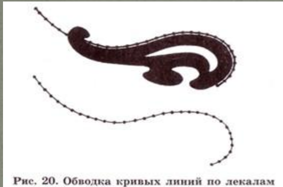
Рис. 20. Обводка кривых линий по лекалам
