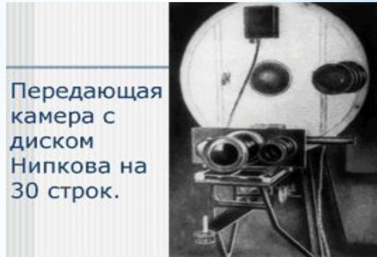
В 1883 г. немецкий студент П. Нипков придумал способ последовательного механического разложения передаваемого изображения на отдельные элементы с помощью вращающегося диска с отверстиями
