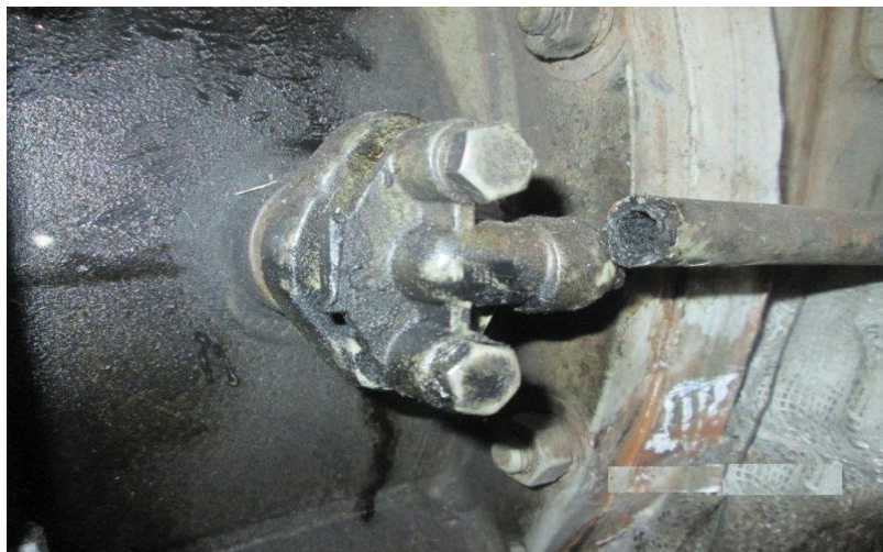
Обрыв трубки на смазку турбокомпрессора 6ТК
