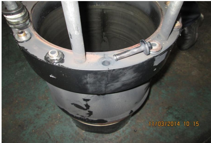
Обрыв трубки на смазку турбокомпрессора 6ТК
