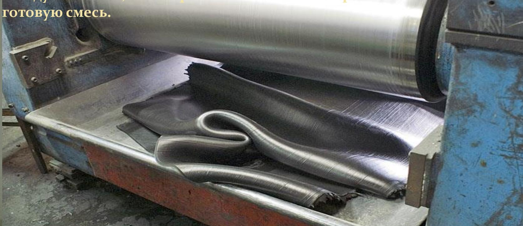
В процессе вальцевания в смесь можно вводить различные добавки. Вальцы – это эффективный диспергирующий смеситель. При диспергирующем смешении разрушение агломератов происходит при достижении некоторого критического напряжения сдвига. Из всех видов смешения диспергирующее смешение является наиболее трудоемким и дорогим процессом. Поэтому часто предварительно готовят концентрат, представляющий собой смесь с высоким содержанием добавок.
