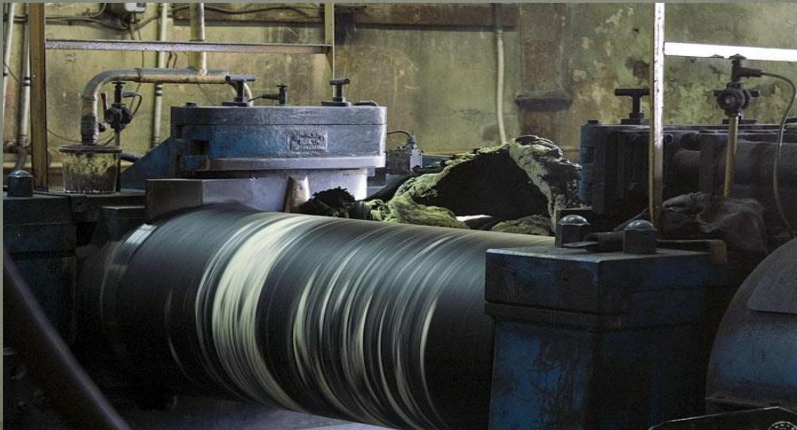
Величину зазора между валками устанавливают в зависимости от адгезионных свойств вальцуемого материала, от его способности прилипать к поверхности одного из валков. В процессе вальцевания постоянно подрезают вальцуемое полотно и многократно пропускают его через зазор валцов, вследствие чего происходит перераспределение элементов поверхности раздела
