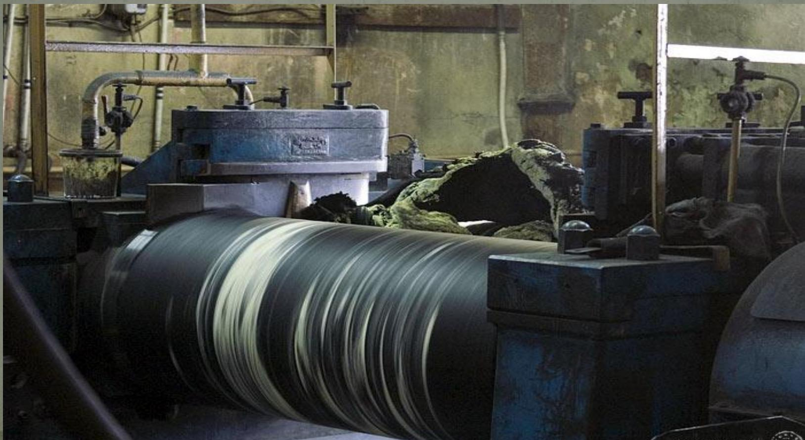
Величину зазора между валками устанавливают в зависимости от адгезионных свойств вальцовываемого материала, от его способности прилипать к поверхности одного из валков. В процессе вальцевания постоянно подрезают вальцовываемое полотно и многократно пропускают его через зазор вальцев, вследствие чего происходит перераспределение элементов поверхности раздела
