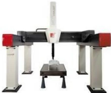
Мостовая архитектура – идеальное решение для контроля крупных автомобильных и авиационных узлов, деталей тяжелого машиностроения, коммуникационного оборудования и т. п.
