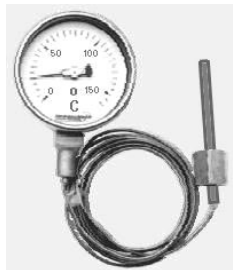
Рис.1.3. Принципиальная схема манометрического термометра
