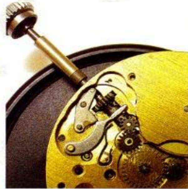
Б. положение перевода стрелок (заводная головка вытянута)
