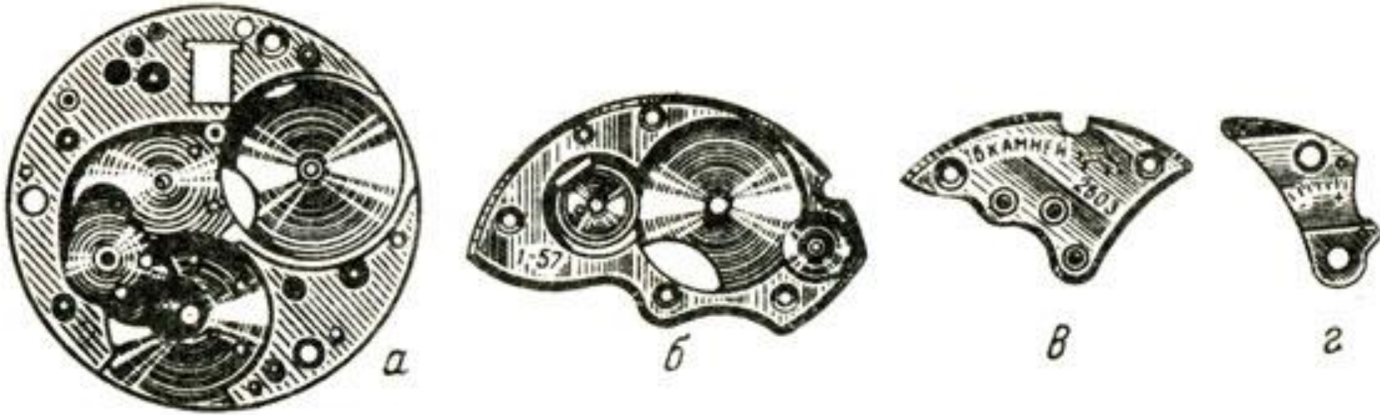
Платина и мосты: а - платина; б - мост барабанный; в - мост колесной передачи; г - мост балансовый
