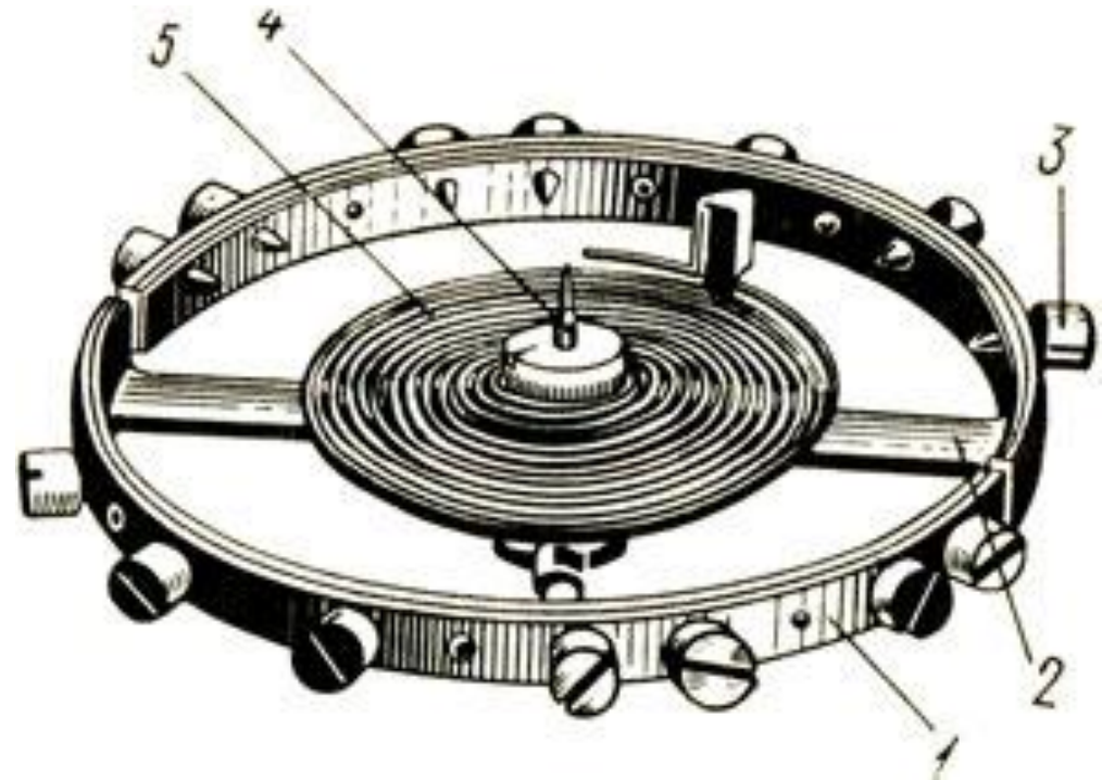
Система баланс-спираль: 1 - обод баланса; 2 - перекладина; 3 - винт для уравнивания; 4 - ось баланса; 5 - спираль
