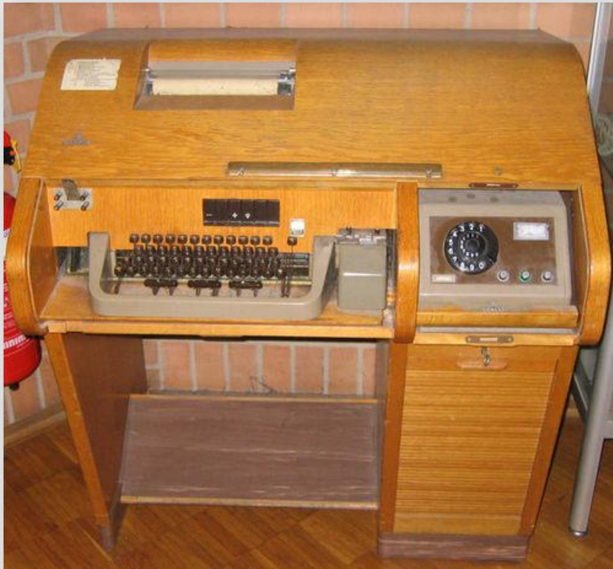
Стартстопный телеграфный аппарат, оснащенный дисковым номеронабирателем телефонного типа (телетайп)
