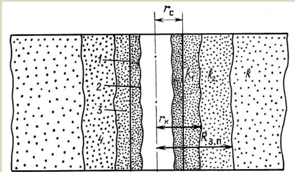
Схема прискважинной зоны пласта после вскрытия его бурением:
