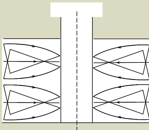
*Схема притока в скважину, несовершенную по характеру вскрытия*
