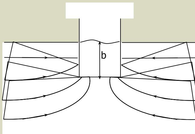
*Схема притока в скважину несовершенную по степени вскрытия*
