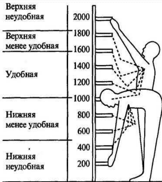
Рис. 1.4. Расположение удобных и неудобных зон на рабочем месте (все размеры указаны в миллиметрах): a, б - на верстаке: 1, А - удобные; 2, Б- менее удобные; 3, В -неудобные; в - удобные и неудобные зоны досягаемости по высоте
