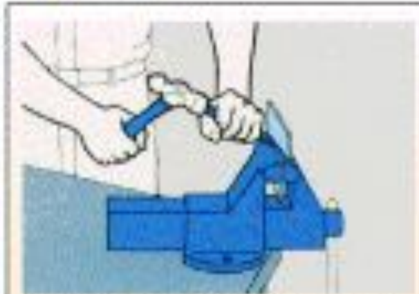
Угол установки зубила при рубке в тисках регулируют так, чтобы лезвие находилось на линии снятия стружки, а продольная ось стержня зубила наклонялась под углом 30-35° к обрабатываемой поверхности
