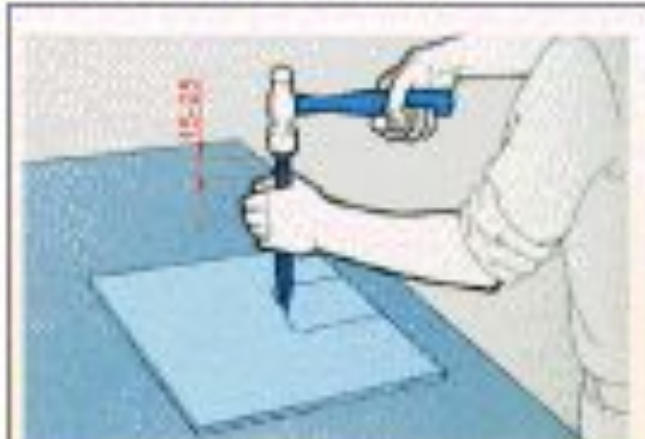
После разметки контура изготавливаемой детали заготовку кладут на плиту и производят вырубку
