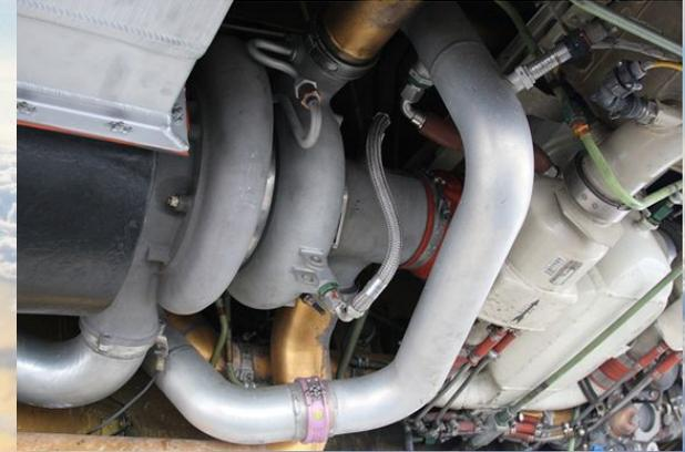
(2) Air Cycle Machine – турбохолодильник, по которому горячий воздух (ещё под давлением), совершает работу по вращению турбины, и при этом расширяется и охлаждается.
