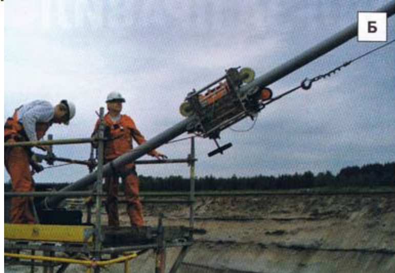
Дефектоскоп ИНТРОС МГ 20-40
