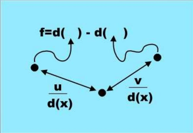
где  $u, v$  — пара векторов смещения, а  $d(x)$  — глубина пиксела, то есть расстояние от Kinect до точки, проецирующейся на  $x$ .
