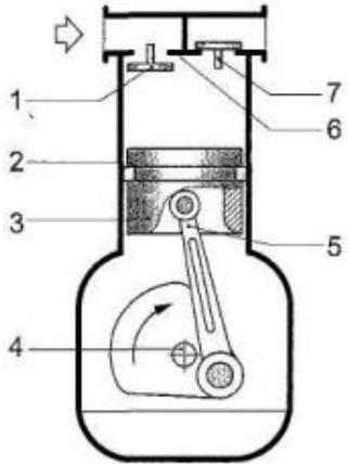
Рис. 3.3. Поршневой компрессор
