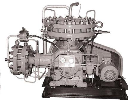
**В мембранном компрессоре** процесс получения сжатого воздуха происходит в принципе так же, как и в поршневом, **стой** лишь **разницей**, что в нем подвижной поршень заменен жестко закрепленной гибкой мембраной 1. Замкнутый объем изменяется за счет деформации мембраны при возвратно-поступательном движении штока 2.
