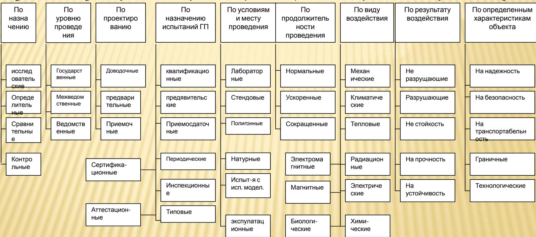
Рис. 2. Классификация испытаний
