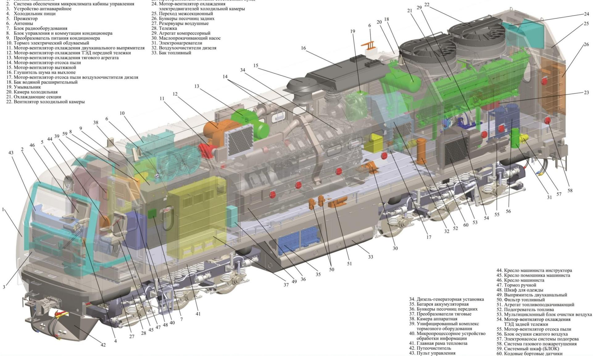
34. Дизель-генераторная установка
